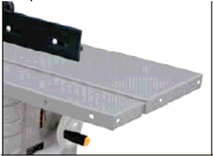
Les extensions se montent de part et d'autre de la table en fonte. Pour cela insérer les tiges filetées pré montés sur les extensions dans les pré trous de la table en fonte et serrer les contre écrous.
