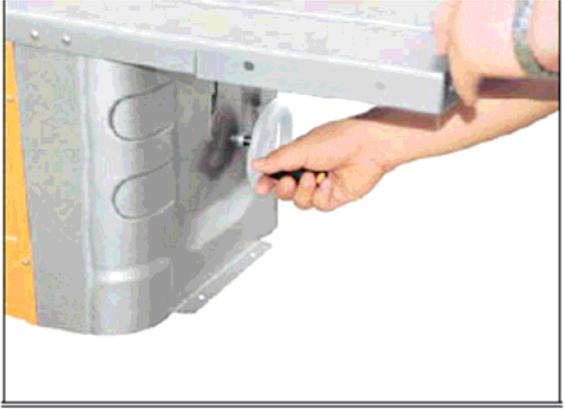
Pour ajuster ou diminuer la hauteur de la course de l'arbre (sert à ajuster la hauteur des fraises), tournez la poignée (cf. schéma) selon que vous souhaitez diminuer ou augmenter la hauteur. Pour votre sécurité, dans la plupart des travaux à effectuer, il est vivement conseillé de travailler avec le porte outils le plus bas possible par rapport à la surface de la table
