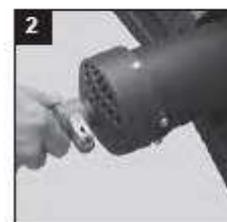
Insérez la lame dans le support inférieur de lame avec la broche située en dessous de la fente du support.
